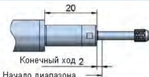
На входе штока в датчик устанавливается двойное фторопластовое уплотнение, выполняющее функции очистки и уплотнения штока, применяется в случае легких загрязнений.
