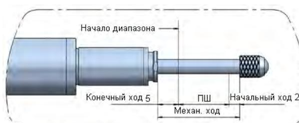
Приведены номинальные значения начального и конечного механического хода (см. укрупненный вид) без изменения выходного сигнала. При калибровке датчиков перед поставкой хода выбираются из соображений наилучшей линейности.
