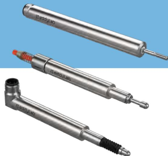
LVDT (линейный переменный дифференциальный трансформатор) представляет вид индуктивных датчиков, предназначенных для применения в жестких, промышленных условиях, при высокой температуре и/или давлении, при больших ускорениях и большом числе циклов перемещений.
